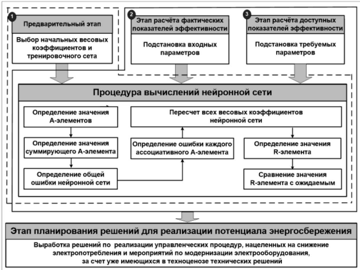
Рис. 4. Этапы определения показателей эффективности при помощи искусственной нейронной сети для реализации потенциала энергосбережения
